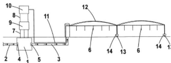
La principal ventaja de esta invención reside en conseguir el movimiento de las líneas de riego por aspersión sin necesidad de líneas eléctricas o de generadores eléctricos autónomos, mediante un dispositivo económico y de fácil mantenimiento.
