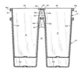
botellas de vidrio que se colocan en el otro compartimiento, de manera que se efectúa una clasificación previa de los artículos reciclables. El contenedor es llevado a un punto de recogida donde los productos preclasificados pueden ser recogidos por un contratista de recolección de reciclaje y se mantienen separados unos de otros durante el transporte a un centro de reciclaje.
