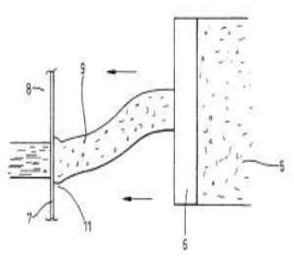
alargados por el paso de la extrusión a través de un troquel de acabado para formar una superficie con textura áspera similar a la madera aserrada y el material plástico se ajusta para mantener la forma y la configuración de la superficie con textura mediante enfriamiento en un baño de agua.
