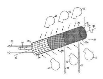
corriente de gas hacia dentro a través de las perforaciones en dicha pared lateral y hacia fuera a través del extremo inferior del tambor para retener y eliminar los materiales relativamente menos densos a través del extremo inferior del tambor
